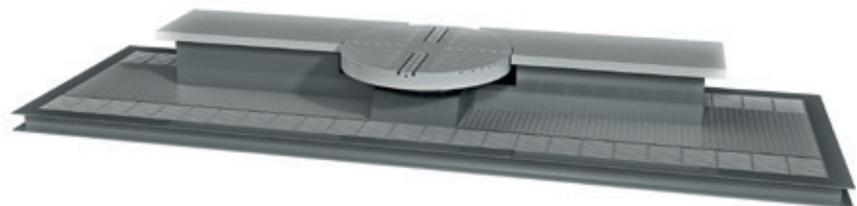
Schwenkbarer Maschinentisch in Brückenbauweise.
