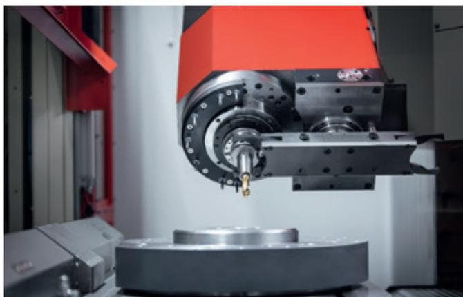
Stufenloser Schwenkkopf für Mehrseiten- oder Endenbearbeitung.
