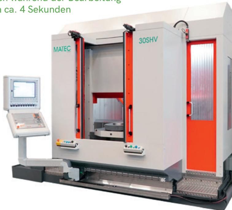
Fahrständer-Bearbeitungszentrum mit Schwenkkopf, ausgelegt für Mittel- und Großserienproduktion. Basismaschine ist die MATEC 30HV mit einem X-Verfahrweg von 2.000 mm. Das Fertigungsprinzip der MATEC 30SHV beruht auf einem 0-180° Pendel-Schwenktisch mit zwei Arbeitsräumen. Der Arbeitsraumwechsel erfolgt durch eine 180°-Drehung des Schwenktisches.
